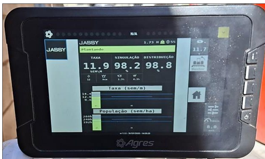
Figura 03 – Alguns parâmetros do dosador de sementes durante o teste do SSBR para grãos de sorgo
