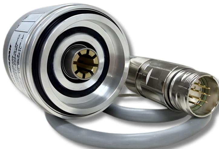
O B58N desenvolvido para o segmento cerâmico. Com resolução de 1 a 10.000 PPR, saída HTL e sinais A, B e Z, ele entrega precisão e confiabilidade em um formato compacto de 58 mm e proteção IP67 (tampa e eixo). Disponível com saída por cabos ou conector lateral, adapta-se facilmente a diferentes configurações de máquina.
