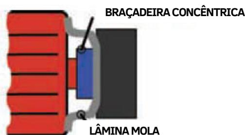
Figura 5: Um encoder de eixo semi-vazado (hubshaft) também pode ser montado diretamente no motor ou no eixo acionado
